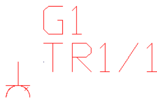
Rys. 22. Symbol gniazda z przypisaną tablicą rozdzielczą TR1 i obwodem 1
